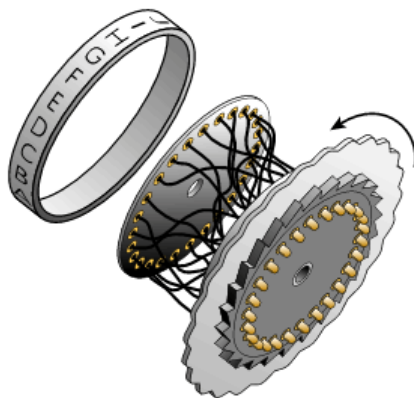
Рис 1. Диск с перепайками.
