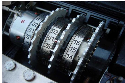
Фотография 2. Три диска внутри шифровальной машины «Энигма» и отражатель, помеченный буквой В.
